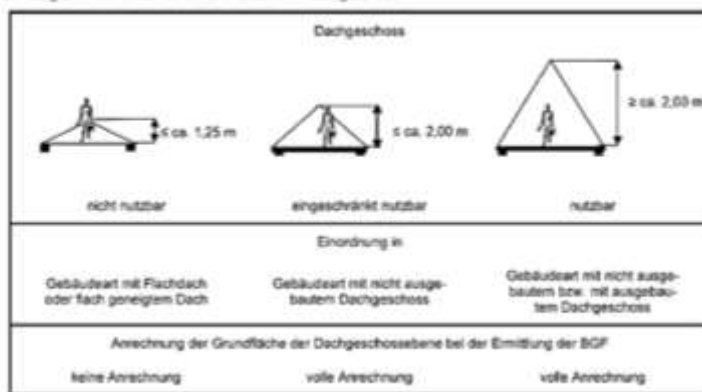
Abbildung 2: Anrechenbarkeit der Grundfläche im Dachgeschoss
